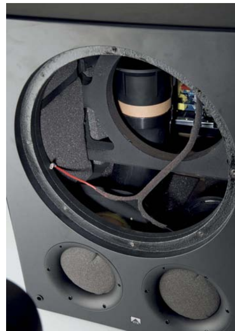
Ett par bilder som jag snott från mitt förra test av 12.17 visar dels hur tjuvisigt stagad lådan är, och dels elementet i all sin glans. Inget bling direkt, men titta till exempel på de stadiga tabsen där högtalarkablarna ansluts. Notera även ur trådarna från kontakterna till talspolen fästs på flera ställen i spidern.
